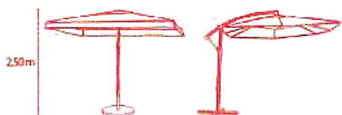
Tipologie di ombrellone a palo centrale e a braccio laterale
