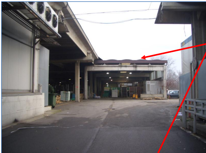
Ampliamento tettoia 34/4 lato Est con struttura prefabbricata e pannelli ondulati curvi in amianto
