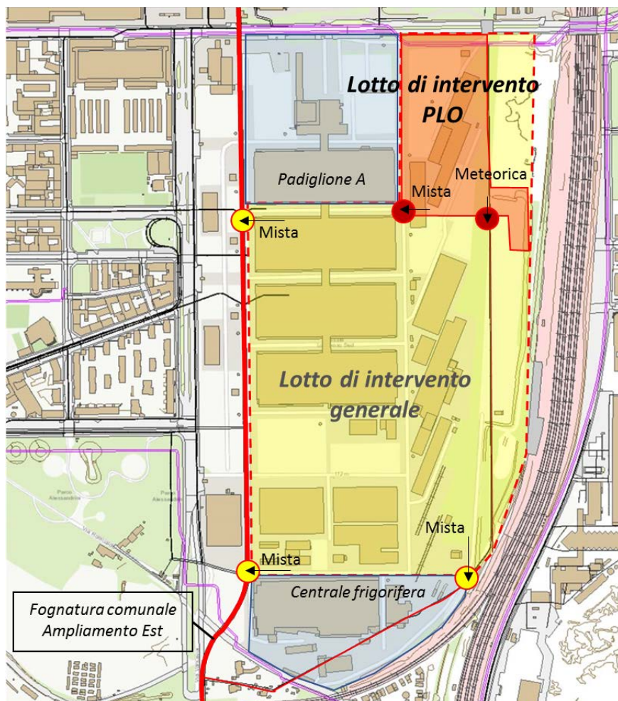
Figura 2. “Recapito del lotto d'intervento generale in fognatura comunale: collettore esistente 4.6m x 3.2m (noto come “ampliamento est”)”
