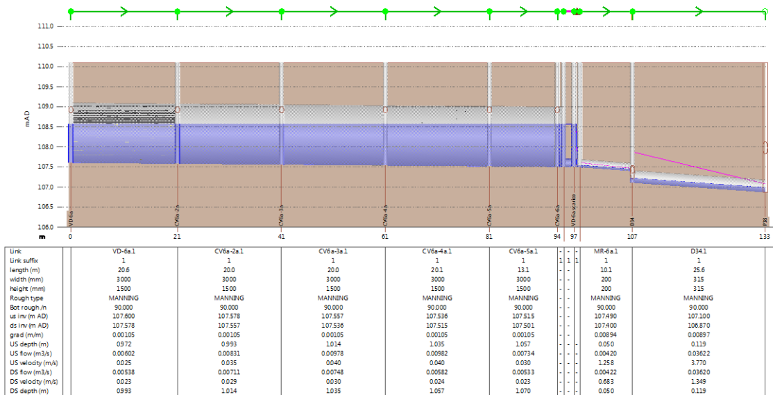
Figura 69. "Profilo longitudinale collettori drenaggio vasca CV-6a da monte al ricettore P18-T50 \Theta=5.5 ore".
