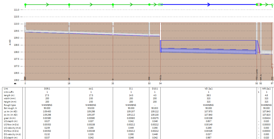
Figura 80. “Profilo longitudinale collettori drenaggio vasca CV-2a dal pozzetto D09 al ricettore P18–T100 Ø=3.5 ore”.
