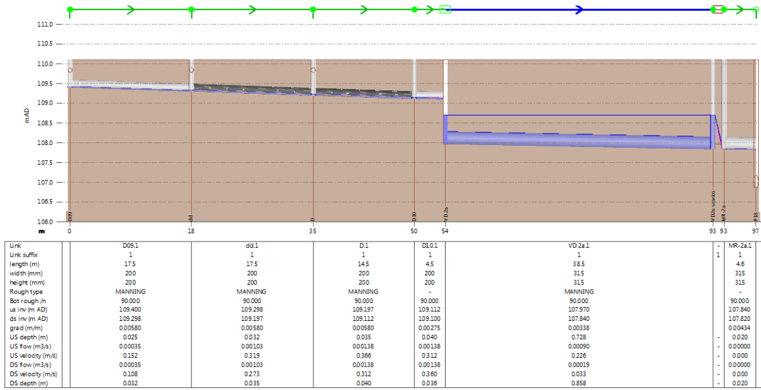
Figura 70. “Profilo longitudinale collettori drenaggio vasca CV-2a dal pozzetto D09 al ricettore P18–T50 \Theta=5.5 ore”.
