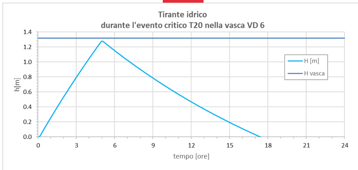
Figura 31. “Andamento del tirante idrico nella vasca per la durata di pioggia critica T20 - V6”
