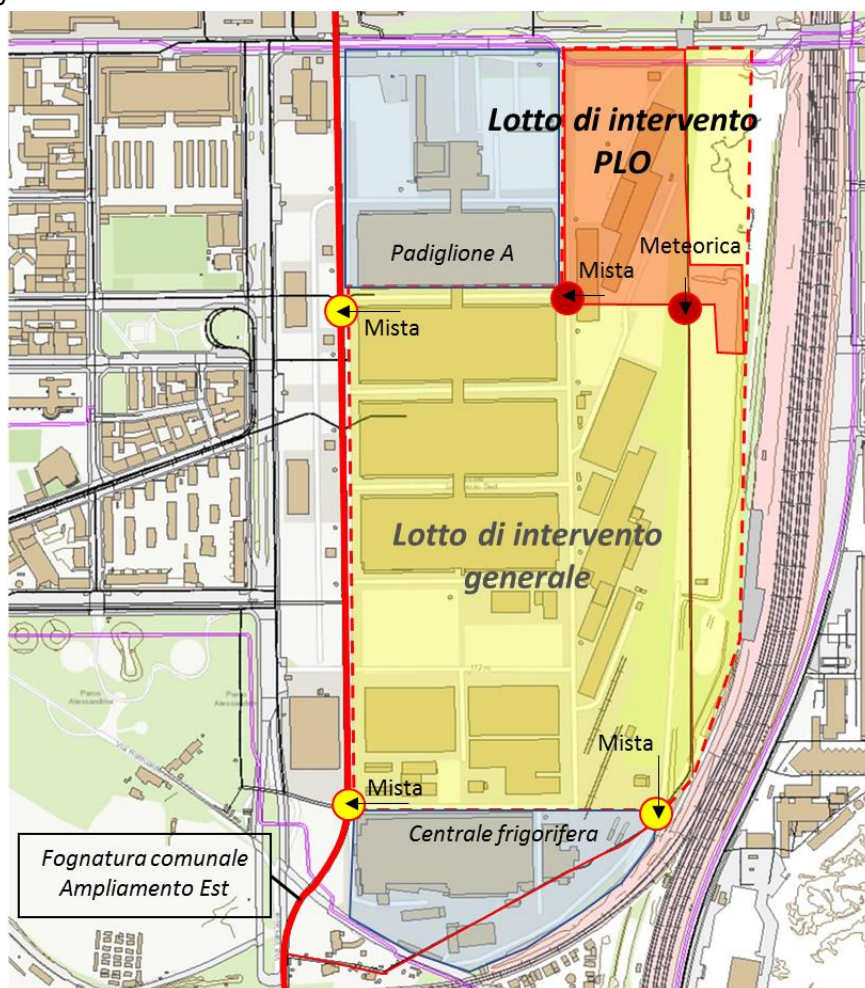
Figura 1. "Recapito del lotto d'intervento attuale e generale in fognatura comunale: collettore esistente 4.6m x 3.2m (noto come "ampliamento est")".
