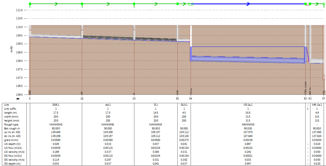
Figura 85. "Profilo longitudinale collettori drenaggio vasca CV-2a dal pozzetto D09 al ricettore P18–T100 Ø=5.5 ore".
