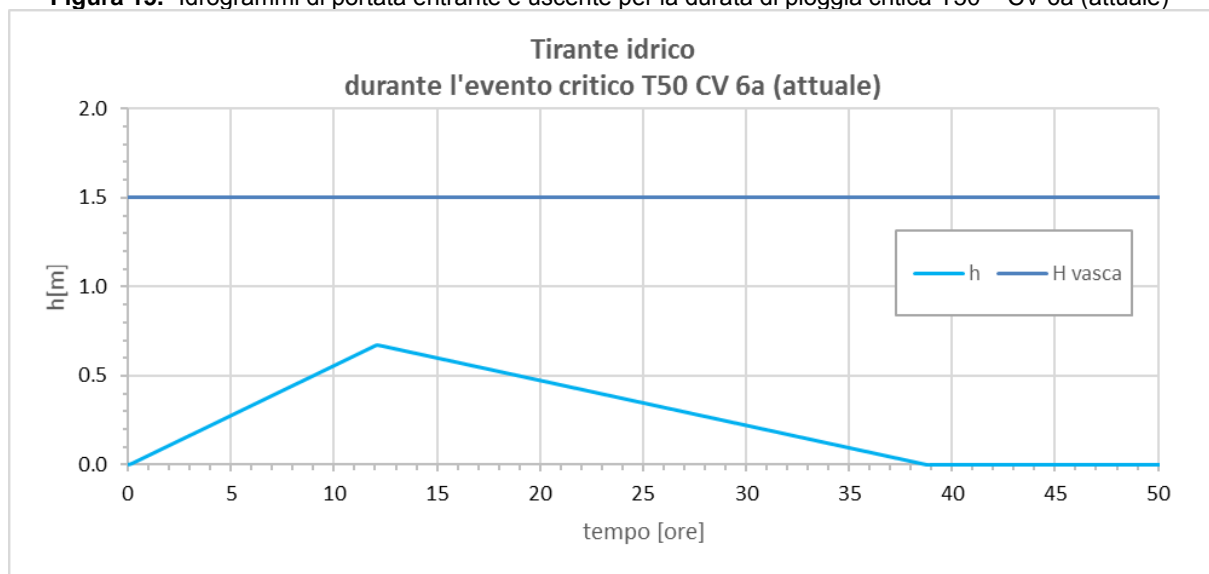
Figura 16. “Andamento del tirante idrico nella vasca per la durata di pioggia critica T50 – CV 6a (attuale)”
