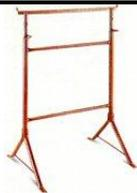
Il ponte su cavalletti è costituito da un impalcato di assi in legno di dimensioni adeguate, sostenuto da cavalletti solitamente metallici, posti a distanze prefissate. La sua utilizzazione riguarda, solitamente, lavori all'interno di edifici, dove a causa delle ridotte altezze e della brevità dei lavori da eseguire, non è consigliabile il montaggio di un ponteggio metallico fisso.
